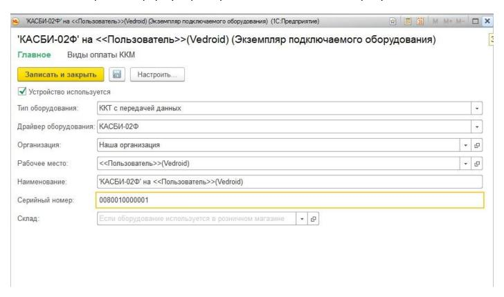
10. Подключаем ККТ КАСБИ-02Ф к компьютеру с помощью интерфейсного кабеля. На форме «Подключение и настройка оборудования» делаем двойной клик по «КАСБИ-02Ф». Вид формы представлен на рисунке ниже.
