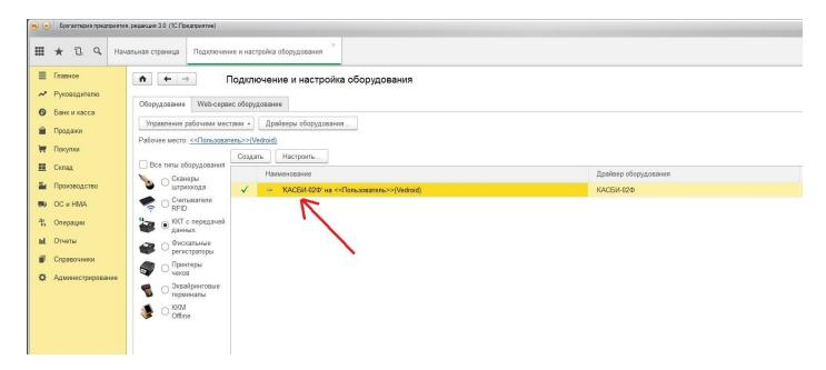
11. В открывшейся форме нажимаем на кнопку «Настроить». Далее в открывшемся окне указываем порт, к которому подключена ККТ и нажимаем на кнопку «Тест устройства». Если все сделано правильно, то
