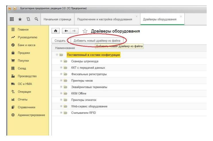
5. Указываем системе путь к архиву с драйвером. В открывшемся окне заполняем поля. Тип оборудования: ККТ с передачей данных, Наименование: КАСБИ-02Ф, Идентификатор объекта: AddIn.KASBIDriver. На рисунке ниже представлен пример правильного заполнения полей формы.
